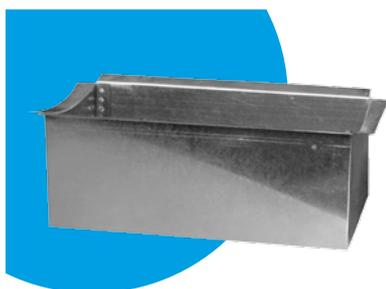
Первой указывается сторона, врезающаяся по длине воздуховода (параллельная), А. Вторая сторона врезки (В) не может быть больше, чем диаметр воздуховода (d). Стандартная длина врезки h=100 мм, по желанию заказчика может быть изменена, стандартная отбортовка - 20 мм.
