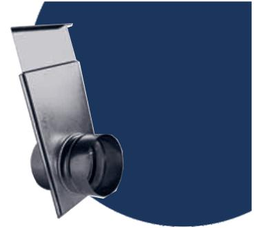
Шибера состоит из корпуса, патрубков и движка. Корпус шибера собирается из двух пластин, соединяемых между собой с помощью отбортовки, на которых закреплены патрубки. Внутри корпуса ставится движок, ход которого ограничен специальной пластиной.
